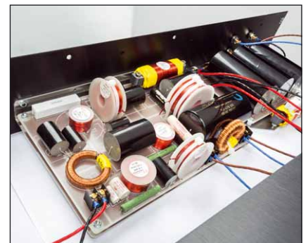
Die Filterung geriet für ein Zweiwegesystem ziemlich aufwendig
